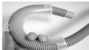
3 Si le tuyau flexible de la machine à laver avec sa guide n'entre pas encore dans le déchargement, retirer le guide en arrière de 5 cm sur le tuyau flexible. Ensuite mettre le tuyau flexible de la machine à laver dans le déchargement.
