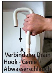
8) Verbinden Sie den Drain Hook mit dem Genie Abwasserschlauch. Schieben Sie den glatten, weißen Teil des Abwasserschlauches ganz in den Drain Hook
