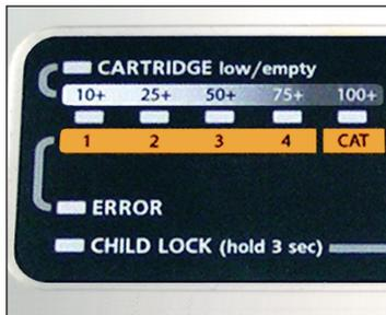
5) Wenn Sie Ihr CatGenie an die Stromversorgung angeschlossen haben, ertönt eine Serie von Signaltönen (Pieps) und alle LEDs leuchten aufeinander folgend. Das bedeutet, Ihr CatGenie arbeitet korrekt. **HINWEIS:** Sollten Sie keine Signaltöne hören, kontrollieren Sie den korrekten Sitz der Processing Unit. Heben Sie sie an und setzen Sie sie vorsichtig wieder richtig ein. Kontrollieren Sie die Stromversorgung.
