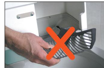
**VORSICHT:** Die Genie Hand ist an der Processing Unit platziert. Bingen Sie die Genie Hand nicht mit Gewalt in ihre Position. Heben Sie die Processing Unit aus ihrer Verankerung und setzen Sie sie wieder korrekt ein. Die Genie Hand wird automatisch in die richtige Position gebracht.
